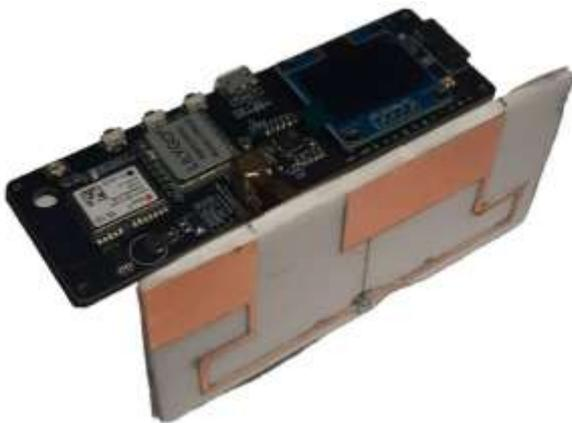
Рис. 6. Модуль LoRa с действующим макетом модифицированной многодиапазонной антенны
