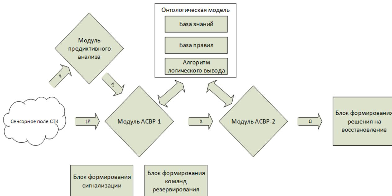
Рис. 2. Схема интеллектуальной системы восстановления работоспособности
