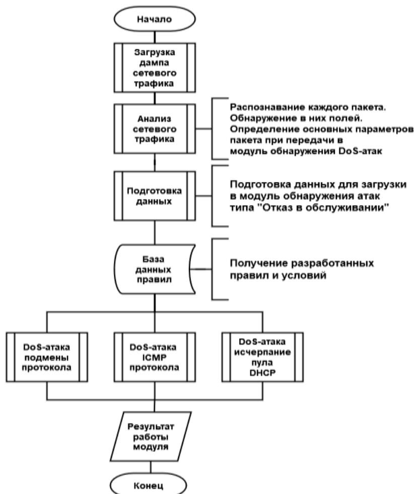
Рис. 1. Блок-схема технологии идентификации вредоносного DoS-трафика
